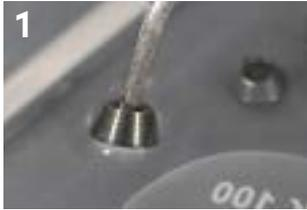
1 接着する前に、99.5%のアルコール（度数95%以上のアルコール）で表面を完全に清浄してください。ユニバーサルベース・ノンエンゲージングのサンドブラスト処理は不要です。必要に応じて、ブラスト処理を行う場合は、接合部をプロテクションアナログで保護してください。
