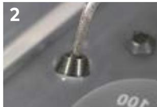
接着する前に、99.5%のアルコール（度数95%以上のアルコール）で表面を完全に清浄してください。ユニバーサルベース・ノンエンゲージングのサンドブラスト処理は不要です。必要に応じて、ブラスト処理を行う場合は、接合部をプロテクションアナログで保護してください。
