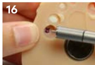
16 プライヤーを用いて、インサーションスクリューをゆっくりとプリンティングモデルアナログの底部に装着します。
