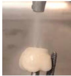
クラウン内面に、最大1気圧で100  $\mu\text{m}$ の酸化アルミニウムをサンドブラストします。
